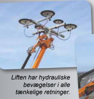
Det multifunktionelle, hydrauliske drejehoved.
