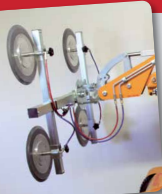
Liftens vakuum er separeret ud i to kredse for højeste sikkerhed. Her ses vakuumkredse med henholdsvis blå og røde vakuumsnanger.
