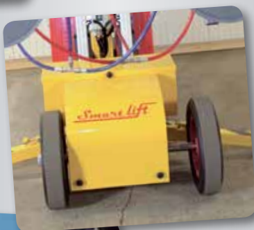
IFTen har sideforskydning til den sidste korrektion af vinduet inden montering
